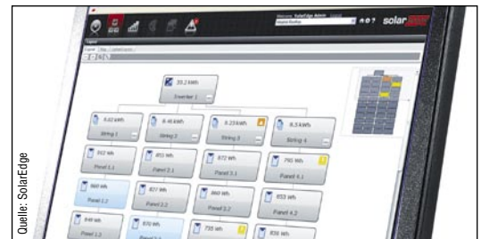
Vollständiger Überblick: Zugriff auf die Leistungsdaten jedes einzelnen Moduls gibt die SolarEdge-Technologie.
